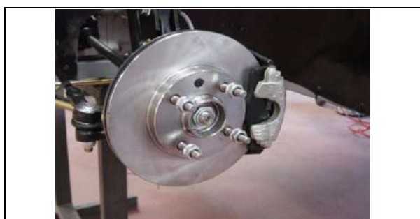
8M) Étrier avec ressort du piston Caliper with piston spring
