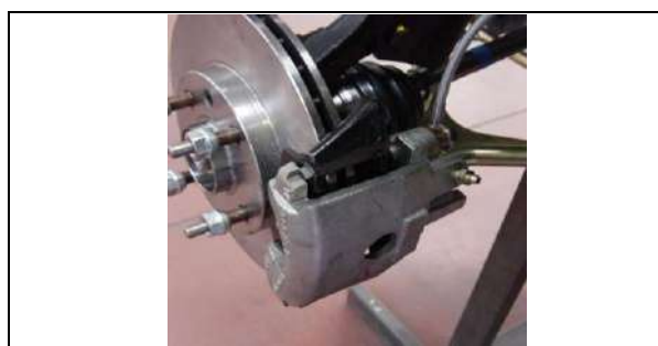
8N) Pompe de frein (diamètre 17,8 mm) Brake pump (diameter 17,8 mm)
