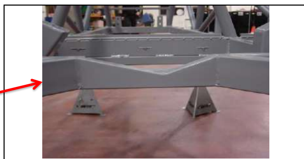
9AD) Modification châssis pour carter moteur FSI Frame modification for engine's carter FSI
