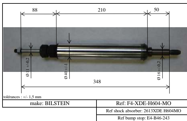
7AD) Ressort compensateur amortisseur arrière déposé Dismounted rear compensating spring
